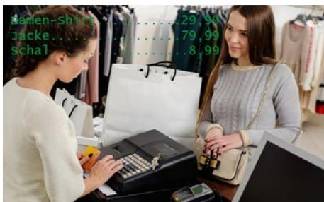
Kassendaten aus einer verbundenen Kasse werden auf dem Livebild einer Kamera eingeblendet. So sehen Sie im Bild was passiert und können direkt anhand der Kassendaten prüfen, ob beim Kassieren fehlerhafte Eingaben gemacht worden sind.
